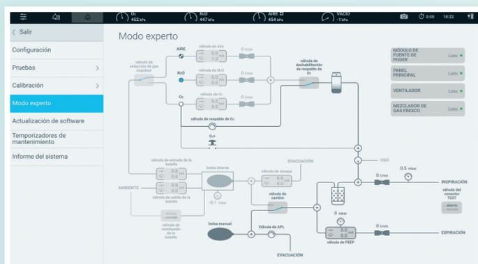
Al iniciar la unidad realiza un autodiagnóstico completo. Los procedimientos de calibración se realizan automáticamente. Las herramientas de diagnóstico, como el "Modo experto", permiten realizar pruebas adicionales de componentes sin necesidad de contar con equipos especiales. El diseño ergonómico de arquitectura neumática hace que la plataforma sea más accesible y el detallado registro de eventos posibilita la solución eficaz de problemas.
